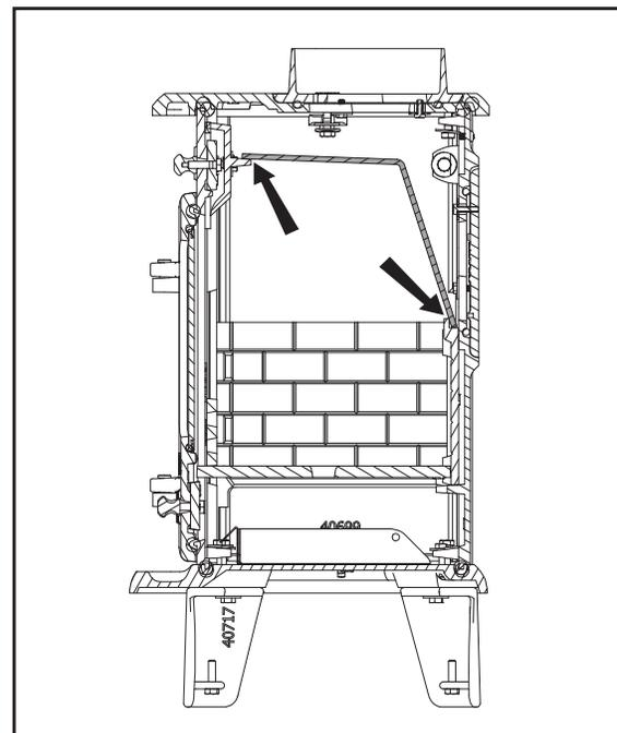
**REMOVING THE BAFFLE**
